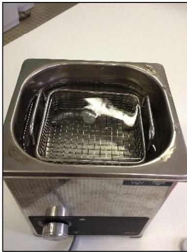
Figure 17 : Cuve à ultrasons (Elma TRANSSONIC 420)
